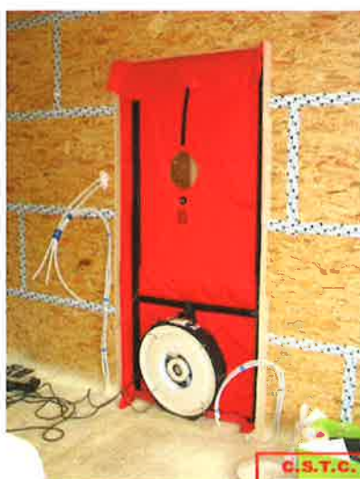
Voorbeeld van luchtverplaatsingapparatuur (Minneapolis Blower Door)
