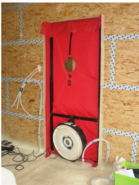
Voorbeeld van luchtverplaatsingapparatuur (Minneapolis Blower Door)
