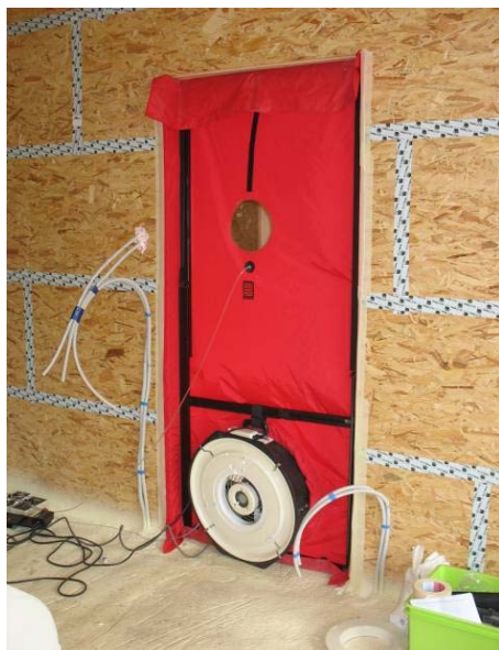
Exemple d'équipement de pressurisation (Minneapolis Blower Door)
