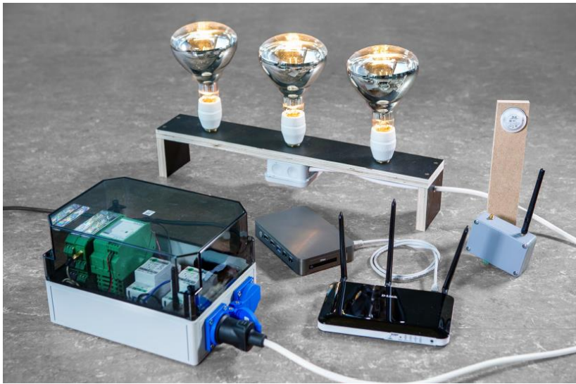
Figuur 8. De co-heatingkit van het WTCB, met als belangrijkste onderdelen lampen voor een gecontroleerde verwarming, en regel- en meetapparatuur.
